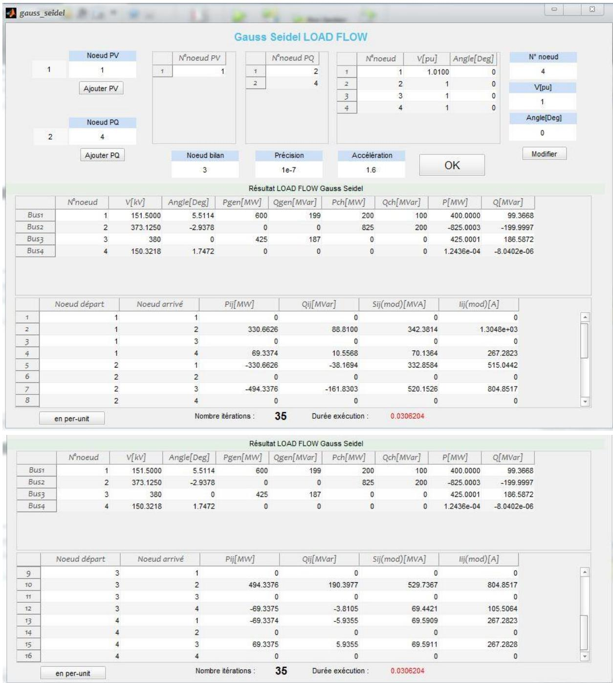
Figure 4.10 : Résultats Load Flow avec la méthode de Gauss-Seidel
