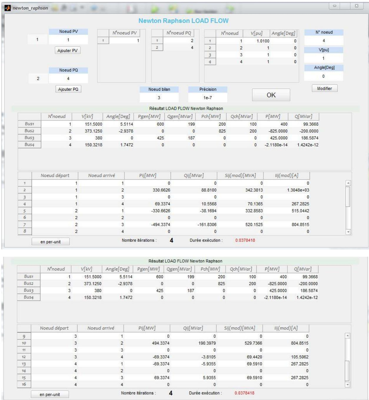
Figure 4.12 : Résultats Load Flow avec la méthode de Newton Raphson
